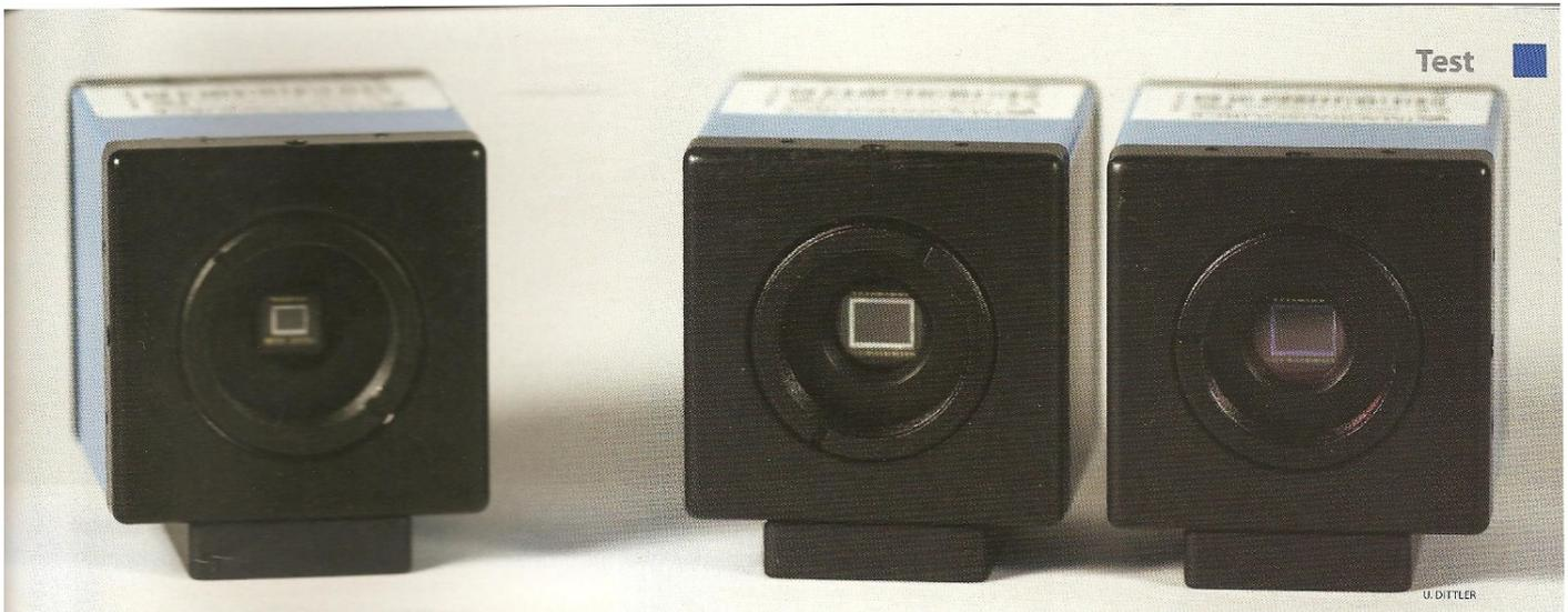
▲ Abb. 2: Der Chip der beiden 51er-Kameras (rechts) im Vergleich zu dem der von Planetenfotografen geschätzten 21er-Baureihe (links).
