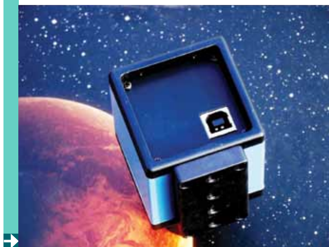
La camera Imaging Source DBK21AU618.AS è molto compatta, si adatta a portaoculari da 31,8 mm e pesa solo 265 g. Sul retro è presente un connettore per il cavo USB, che porta anche l'alimentazione alla camera.
