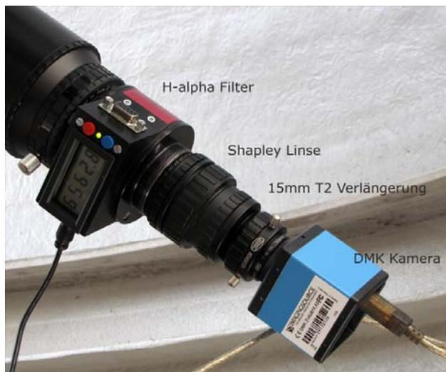
**Rot:** 150mm Schaer Refraktor mit Day-Star H-alpha Filter, Halbwertsbreite ca. 0.5 Angström (656 nm). Das Objektiv war auf ca. 80 mm abgeblendet um den f/30 erforderlichen Strahlengang zu erreichen.
