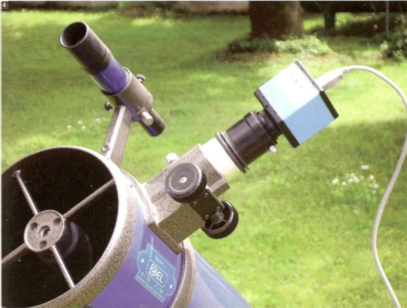
4. Le camere *Imaging Source* pesano solo 265 g e non inducono vibrazioni o derive, anche se accoppiate a telescopi di piccolo diametro. Si collegano al PC tramite un unico cavo USB, che fornisce anche l'alimentazione.
